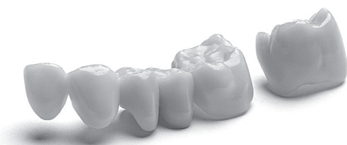
図5 DWS社の小型レーザー機による人工歯の造形例
