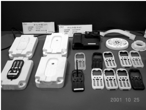
図-4b エポキシ系樹脂 TSR-2081 による型とその ABS 成型物
