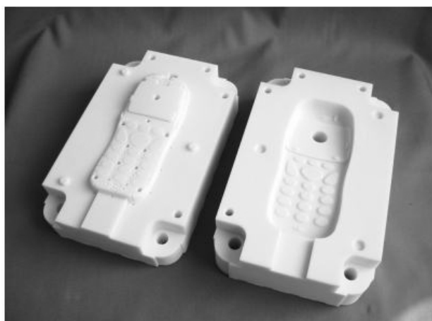
図-3 造形して得たダイレクト型(TSR-2081 樹脂、後加工処理前)
