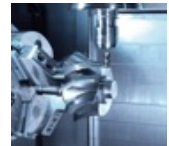
Hybrid (DED + 切削) MAZAK/インテグレックスiAM
